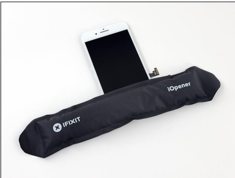
ⓘ Il riscaldamento dell'area attorno al sensore home/Touch ID aiuta ad ammorbidire l'adesivo che tiene in posizione il suo delicato cavo, rendendo più facile e sicura la rimozione.
